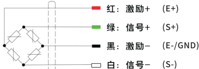
图14 称重传感器接线
