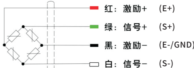
图14 称重传感器接线
