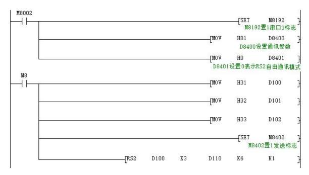
使用串口工具监控串口 3 得到的数据为: [2017:11:01:11:49:16][接收]31 32 32 RS2 指令最后参数=1:串口 3;
