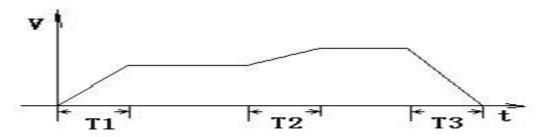
加减速时间 T 计算: (目标速度---当前速度)\*加减速时间/最高速度
