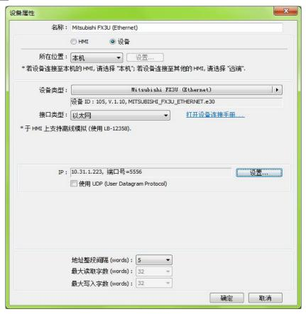
如上图设置表示触摸屏要访问 IP 为 10. 31. 1. 223 的 PLC, 端口为 5556。b. 昆仑屏设置:
