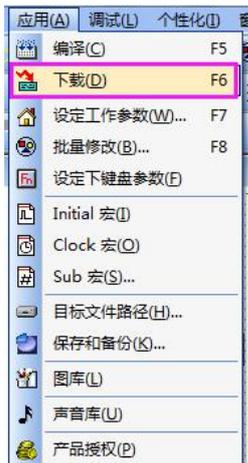
4. 弹出下载窗口，待出现 HMI 连接 OK, IP 设置 OK，等待下载命令提示后，再点击下载；
